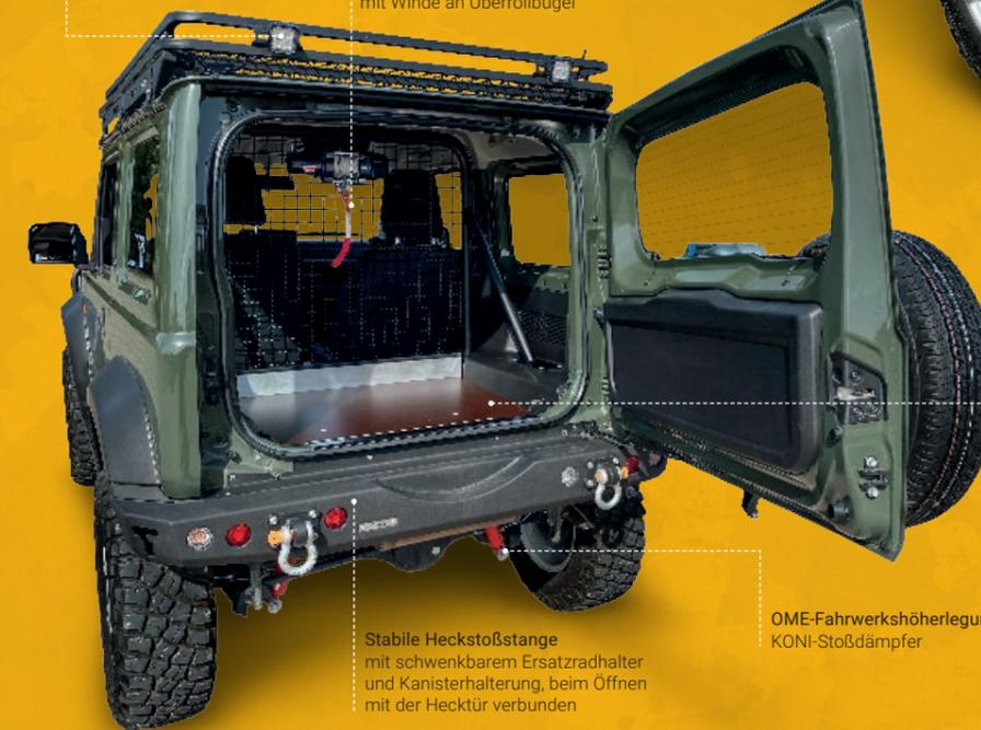
Stabile Heckstoßstange mit schwenkbarem Ersatzradhalter und Kanisterhalterung, beim Öffnen mit der Hecktür verbunden
