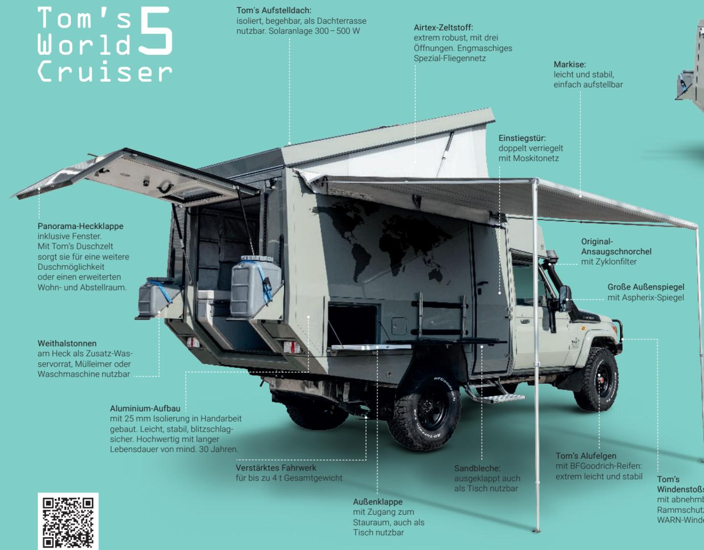
**Tom's Aufstelldach:** isoliert, begehbar, als Dachterrasse nutzbar. Solaranlage 300–500 W
